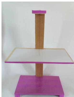
**Figura 2: Aparato de madeira com o fio de cobre passando pela folha de papel.**
