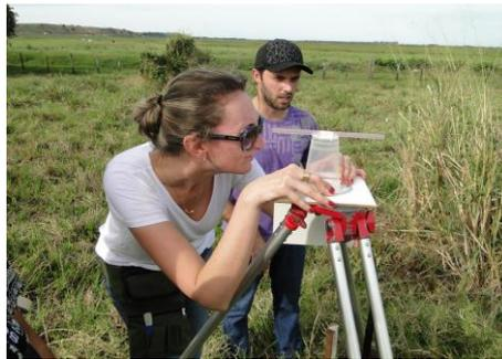
**Figura 5: Medição dos ângulos internos da poligonal**
